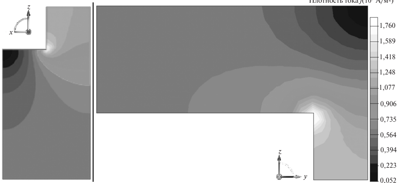
Рис. 4. Распределение плотности тока на участках витка
