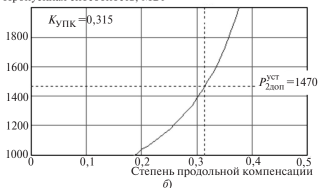
Рис. 4. Определение степени емкостной компенсации, при которой обеспечивается такая же пропускная способность, как и для схемы на рис. 2,б: а – схема с одной УПК (рис. 2,б); б – схема с двумя УПК (рис. 2,в)
