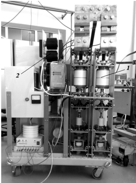
Рис. 2. Быстродействующий вакуумный выключатель: 1 – ВДК; 2 – блок ОПН
