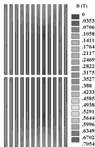
Рис. 11. Распределение магнитного поля в срединном сечении прямой части катушки, намотанной лентой AMSC при амплитудном значении тока 80 А
