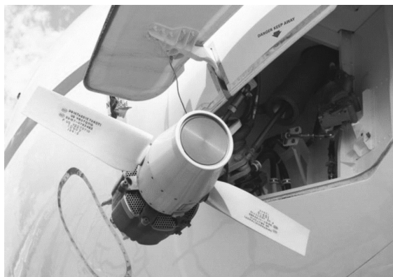
Рис. 1. Аварийная авиационная ветроэлектрическая установка самолета Embraer 190–100
