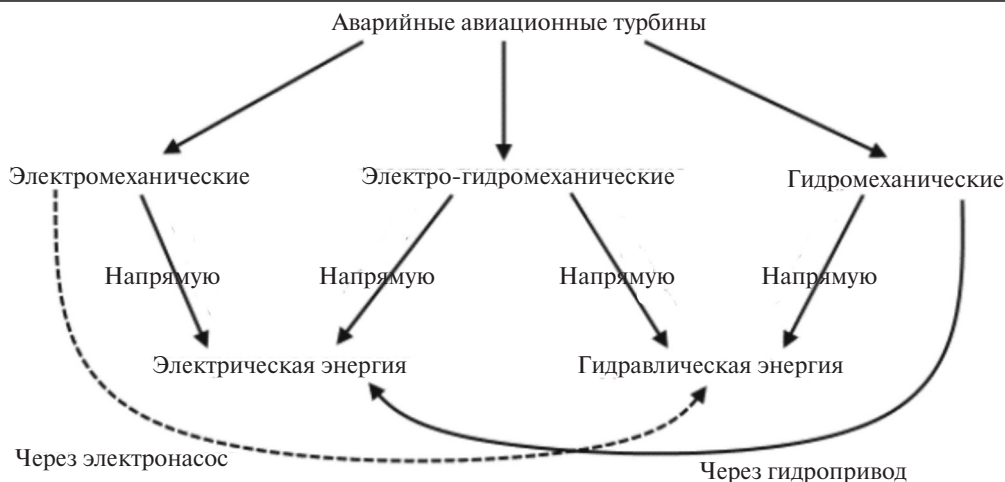
Рис. 2. Классификация аварийных авиационных турбин
