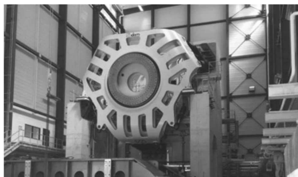
Рис. 1. Ветрогенератор мощностью 3,6 МВт с возбуждением на основе сверхпроводящей керамики (проект EcoSwing)
