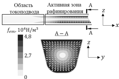
Рис. 10. Распределение электромагнитных сил в расплаве
